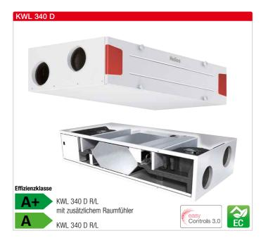
Extrem flache Deckengeräte mit Wärmerückgewinnung für die zentrale Be- und Entlüftung von Geschosswohnungen und kleinen Einfamilienhäusern. Ausgestattet mit Helios easyControls 3.0, dem innovativen Steuerungskonzept für einfachste Netzwerkanbindung und Webbrowser-Bedienung. Mit hocheffizientem Kunststoff-Wärmetauscher und energieeffizienten EC-Motoren.
