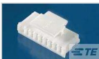
Produkttyp des Steckverbinders: **Gehäuse**Steckverbinder- und Gehäusertyp: **Buchse**Steckverbindersystem: **Draht-an-Leiterplatte**Anzahl von Positionen: **13**Raster: **2 mm [.079 in]**[Alle AMP HPI 2.0 mm Receptacle Housings \(60\)](#)**Eigenschaften****Produktmerkmale**
