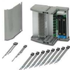
Termination Carrier zur redundanten Anbindung von 16 MINI Analog Trennverstärkern an analoge Eingangskarten der Yokogawa CENTUM VP Steuerung, über KS40-Steckverbinder, 40-polig. Geeignet für die Yokogawa-Karte AA1543.
