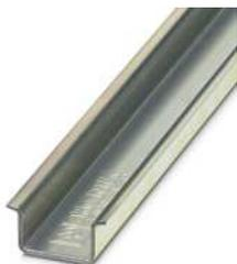
Tragschiene ungelocht, ähnlich EN 60715, Material: Stahl, verzinkt, dickschichtpassiviert, Standardprofil, Farbe: silberfarben, Verpackungsvariante mit 25 Stück (50 m)
