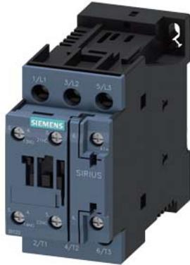
Leistungsschütz, AC-3 38 A, 18,5 kW / 400 V 1 S + 1 Ö, DC 110 V 3-polig, Baugröße S0 Schraubanschluss
