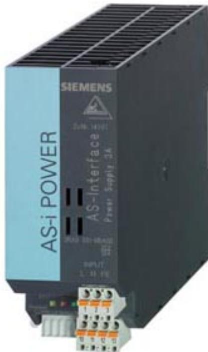
AS-i Power 3A AC 120V/230V AS-Interface Netzteil, IP20 IN: AC 120 V / 230 V OUT: AS-i, 3A (DC 30 V), IP20 mit integrierter Erdschlusserkennung, mit integrierter Überlasterkennung mit AS-i Datenentkopplung
