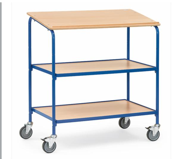
Rollpult aus Stahlrohr und Profilstahl geschweißt, Schraubkonstruktion, pulverbeschichtet, blau RAL 5007. Schreibfläche Holzwerkstoffplatte 1100 x 589 mm, mit Anschlagleiste, 2 Ablageböden variabel einschraubbar, 2 Ordnerreihen möglich. Schreibfläche ca. 10° geneigt. Tragkraft pro Boden 50 kg. 4 Lenkrollen mit TPE-Bereifung, Naben mit Gleitlager. 2 Stück mit Feststeller, gemäß der Europäischen Norm EN 1757-3 (Sicherheit von Plattformwagen).
