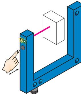
T-Taste < 20 s loslassen. Bei erfolgreichem Teach-in zeigt die Funktionsanzeige (gelbe LED) direkt den Schaltzustand des Sensors an. Die Schaltschwelle ist nun optimal zwischen Hintergrund und Objekt gesetzt. Die bestmögliche Betriebssicherheit ist gegeben.
