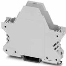
Tragschienengehäuse, Gehäuseunterteil mit Metallfußriegel, flache Bauform, mit Lüftungsschlitzen, Breite: 22,6 mm, Höhe: 99 mm, Tiefe: 84,8 mm, Farbe: lichtgrau (7035), Querverbindung: ohne Busverbinder, Polzahl Querverbinder: nicht relevant
