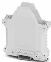
Tragschienengehäuse, Gehäuseunterteil mit Metallfußriegel, mit FE-Kontakt, hohe Bauform, ohne Lüftungsschlitze, Breite: 22,6 mm, Höhe: 99 mm, Tiefe: 107,3 mm, Farbe: lichtgrau (7035), Querverbindung: integrierter Busverbinder, Polzahl Querverbinder: 10+2, Busverbinder: 10 parallele Kontakte, 2 serielle Kontakte
