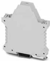
Tragschienengehäuse, Gehäuseunterteil mit Metallfußriegel, hohe Bauform, ohne Lüftungsschlitze, Breite: 22,6 mm, Höhe: 99 mm, Tiefe: 107,3 mm, Farbe: lichtgrau (7035), Querverbindung: ohne Busverbinder, Polzahl Querverbinder: nicht relevant
