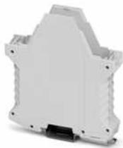
Tragschienengehäuse, Gehäuseunterteil mit Metallfußriegel, hohe Bauform, mit Lüftungsschlitzen, Breite: 22,6 mm, Höhe: 99 mm, Tiefe: 107,3 mm, Farbe: lichtgrau (7035), Querverbindung: Tragschienen-Busverbinder (optional), Polzahl Querverbinder: 5
