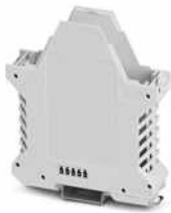
Tragschienengehäuse, Gehäuseunterteil mit Metallfußriegel, mit FE-Kontakt, hohe Bauform, mit Lüftungsschlitzen, Breite: 22,6 mm, Höhe: 99 mm, Tiefe: 107,3 mm, Farbe: lichtgrau (7035), Querverbindung: integrierter Busverbinder, Polzahl Querverbinder: 5, Busverbinder: 5 parallele Kontakte
