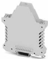
Tragschienengehäuse, Gehäuseunterteil mit Metallfußriegel, mit FE-Kontakt, hohe Bauform, mit Lüftungsschlitzen, Breite: 22,6 mm, Höhe: 99 mm, Tiefe: 107,3 mm, Farbe: lichtgrau (7035), Querverbindung: integrierter Busverbinder, Polzahl Querverbinder: 10, Busverbinder: 10 Parallelkontakte
