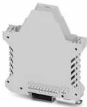
Tragschienengehäuse, Gehäuseunterteil mit Metallfußriegel, mit FE-Kontakt, hohe Bauform, mit Lüftungsschlitzen, Breite: 22,6 mm, Höhe: 99 mm, Tiefe: 107,3 mm, Farbe: lichtgrau (7035), Querverbindung: integrierter Busverbinder, Polzahl Querverbinder: 10+2, Busverbinder: 10 parallele Kontakte, 2 serielle Kontakte
