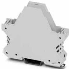
Tragschienengehäuse, Gehäuseunterteil mit Metallfußriegel und FE-Kontakt, flache Bauform, mit Lüftungsschlitzen, Breite: 22,6 mm, Höhe: 99 mm, Tiefe: 84,8 mm, Farbe: lichtgrau (7035), Querverbindung: ohne Busverbinder, Polzahl Querverbinder: nicht relevant
