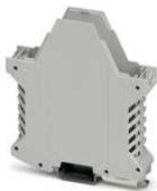
Tragschienegehäuse, Gehäuseunterteil mit Metallfußriegel, hohe Bauform, mit Lüftungsschlitzen, Breite: 22,6 mm, Höhe: 99 mm, Tiefe: 107,3 mm, Farbe: lichtgrau (7035), Querverbindung: ohne Busverbinder, Polzahl Querverbinder: nicht relevant
