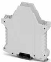
Tragschienengehäuse, Gehäuseunterteil mit Metallfußriegel, hohe Bauform, ohne Lüftungsschlitze, Breite: 22,6 mm, Höhe: 99 mm, Tiefe: 107,3 mm, Farbe: lichtgrau (7035), Querverbindung: Tragschienen-Busverbinder (optional), Polzahl Querverbinder: 5
