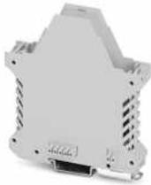
Tragschienengehäuse, Gehäuseunterteil mit Metallfußriegel, mit FE-Kontakt, hohe Bauform, mit Lüftungsschlitzen, Breite: 22,6 mm, Höhe: 99 mm, Tiefe: 107,3 mm, Farbe: lichtgrau (7035), Querverbindung: integrierter Busverbinder, Polzahl Querverbinder: 5+2, Busverbinder: 5 parallele Kontakte, 2 serielle Kontakte
