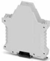
Tragschienengehäuse, Gehäuseunterteil mit Metallfußriegel, mit FE-Kontakt, hohe Bauform, ohne Lüftungsschlitze, Breite: 22,6 mm, Höhe: 99 mm, Tiefe: 107,3 mm, Farbe: lichtgrau (7035), Querverbindung: Tragschienen-Busverbinder (optional), Polzahl Querverbinder: 5
