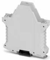
Tragschienengehäuse, Gehäuseunterteil mit Metallfußriegel, mit FE-Kontakt, hohe Bauform, mit Lüftungsschlitzen, Breite: 22,6 mm, Höhe: 99 mm, Tiefe: 107,3 mm, Farbe: lichtgrau (7035), Querverbindung: Tragschienen-Busverbinder (optional), Polzahl Querverbinder: 5
