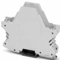
Tragschienengehäuse, Gehäuseunterteil mit Metallfußriegel, flache Bauform, mit Lüftungsschlitzen, Breite: 22,6 mm, Höhe: 99 mm, Tiefe: 84,8 mm, Farbe: lichtgrau (7035), Querverbindung: Tragschienen-Busverbinder (optional), Polzahl Querverbinder: 5
