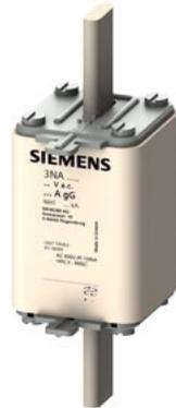
NH-Sicherungseinsatz, NH1, In: 200 A, gG, Un AC: 500 V, Un DC: 440 V, Stirnkennmelder, spannungsführende Griffflaschen
