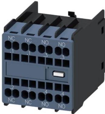
Hilfsschalter, frontseitig, 2 S + 2 Ö, .1/2, .1/2, .3/4, .3/4, Strombahn: 1 Ö, 1 Ö, 1 S, 1 S, Federzuganschluss, für Schütze 3RT2 und Hilfsschütze 3RH2
