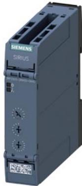
Zeitrelais, Multifunktion mit lackierter Flachbaugruppe 2 Wechsler, 13 Funktionen zwangsgeführte Relais-Kontakte AC/DC 24...240 V bei AC 50/60 Hz 7 Zeitbereiche (0,05 s...100 h) mit LED Federzuganschluss (Push-In)
