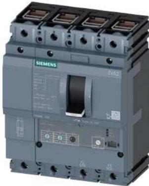
Leistungsschalter 3VA2 IEC Frame 100 Schaltvermögenklasse H Icu=85kA @ 415V 4-polig, Anlagenschutz ETU320, LI, In=63A Überlastschutz Ir=25A...63A Kurzschlusschutz Ii=1,5...12 x In N-Leiterschutz einstellbar (OFF, 100%) Klemmenanschluss
