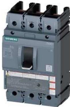
Leistungsschalter 3VA5 UL Frame 250 Schaltvermögenklasse M 35kA @ 480 V 3-polig, Anlagenschutz TM210, FTFM, In=15A Überlastschutz, 100%-rated Ir=15A fest eingestellt Kurzschlusschutz Ii=23,3 x In ohne Anschluss
