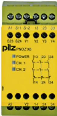
Sicherheitsschaltgerät (standalone), Eingänge: 1/2-kanalige Beschaltung ohne Querschlusserkennung, Ausgänge: 3 S, automatischer/manueller/überwachter Start, UB = 24 V AC/DC, Breite: 45 mm, Schraubklemmen integriert, Überwachung von Not-Halt, Schutztüren.
