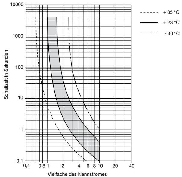
Die Zeit/Strom-Kennlinien sind abhängig von den Umgebungstemperaturen. Um eine vorzeitige oder späte Abschaltung zu vermeiden, muss der Schutzschalterennstrom mit einem Temperaturfaktor multipliziert werden (siehe auch Kapitel Technische Informationen).
