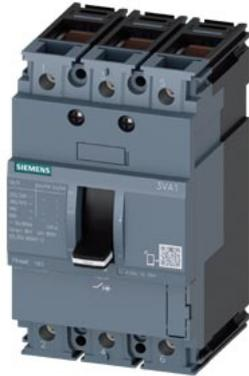
Leistungsschalter 3VA1 IEC Frame 160 Schaltvermögenklasse N Icu=25kA @ 415V 3-polig, Anlagenschutz TM210, FTFM, In=80A Überlastschutz Ir=80A fest eingestellt Kurzschlusschutz Ii=10 x In Klemmenanschluss
