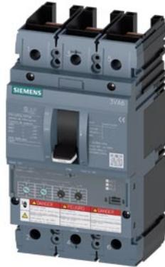
Leistungsschalter 3VA6 UL Frame 150 Schaltvermögenklasse E 200 kA @ 480 V 3-polig, Anlagenschutz ETU330, LIG, In=100A Überlastschutz Ir=40A ... 100A Kurzschlusschutz Ii=1,5...12 x In Erdschlusschutz Ig=0,2... 1 x In, tg=0,1/0,3s ohne Anschluss
