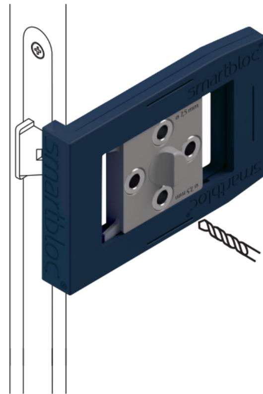
Löcher präzise nach der jeweiligen Montageanleitung bohren. **Niemals durchbohren, immer von beiden Seiten einzeln bohren!**
