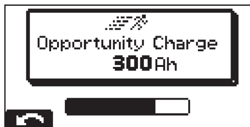
Anzeige bei Start der Zwischenladung
