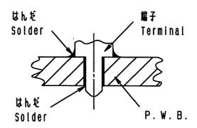
基板に挿入される金属足ははんだ付けしてご使用願います。 Solder all metal inserted fixing including terminals & metal lugs into a substrate.
