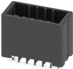
Leiterplatten-Grundleiste, Farbe: schwarz, Nennstrom: 8 A, Bemessungsspannung (III/2): 160 V, Kontaktoberfläche: Zinn, Kontaktart: Stift, Anzahl der Reihen: 2, Polzahl: 10, Artikelfamilie: DD31H 2,2/..-V, Rastermaß: 3,81 mm, Montage: Wellenlöten, Pin-Layout: Lineares Pinning, Pinlänge [P]: 3,8 mm, Anzahl der Lötpins pro Potenzial: 1, Stecksystem: CONNEXIS DD, Ausrichtung Steckgesicht: Standard, Verriegelung: Rastverriegelung, Befestigungsart: Rastnase, Verpackungsart: verpackt im Karton
