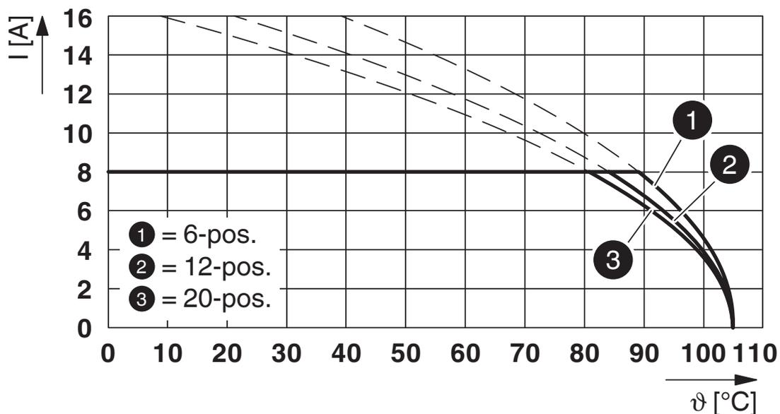
Typ: DD31PC 2,2/...-3,81-X mit DD31H 2,2/...-PT-3,81-X
