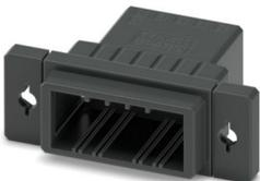
Durchführungsstecker, Farbe: schwarz, Nennstrom: 8 A, Bemessungsspannung (III/2): 160 V, Kontaktart: Stift, Anzahl der Reihen: 2, Polzahl: 10, Artikelfamilie: DD31H 2,2/..-PT, Rastermaß: 3,81 mm, Anschlussart: Crimpanschluss, Anschlussrichtung Leiter/Platine: 0 °, Pin-Layout: Lineares Pinning, Rasthaken: - ohne Rasthaken, Stecksystem: CONNEXIS DD, Ausrichtung Steckgesicht: Standard, Verriegelung: Rastverriegelung, Befestigungsart: Rastnase, Verpackungsart: verpackt im Karton
