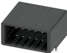
Leiterplatten-Grundleiste, Farbe: schwarz, Nennstrom: 8 A, Bemessungsspannung (III/2): 160 V, Kontaktoberfläche: Zinn, Kontaktart: Stift, Anzahl der Reihen: 2, Polzahl: 10, Artikelfamilie: DD31H 2,2/..-H, Rastermaß: 3,81 mm, Montage: Wellenlöten, Pin-Layout: Lineares Pinning, Pinlänge [P]: 3,8 mm, Anzahl der Lötpins pro Potenzial: 1, Stecksystem: CONNEXIS DD, Ausrichtung Steckgesicht: Standard, Verriegelung: Rastverriegelung, Befestigungsart: Rastnase, Verpackungsart: verpackt im Karton
