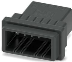
Leiterplattenstecker, Farbe: schwarz, Nennstrom: 8 A, Bemessungsspannung (III/2): 160 V, Kontaktart: Stift, Anzahl der Reihen: 2, Polzahl: 10, Artikelfamilie: DD31H 2,2/..-FH, Rastermaß: 3,81 mm, Anschlussart: Crimpanschluss, Anschlussrichtung Leiter/Platine: 0 °, Pin-Layout: Lineares Pinning, Rasthaken: - ohne Rasthaken, Stecksystem: CONNEXIS DD, Verriegelung: Rastverriegelung, Befestigungsart: Rastnase, Verpackungsart: verpackt im Karton
