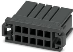
Leiterplattenstecker, Farbe: schwarz, Nennstrom: 8 A, Bemessungsspannung (III/2): 160 V, Kontaktart: Buchse, Anzahl der Reihen: 2, Polzahl: 10, Artikelfamilie: DD31PC 2,2/..., Rastermaß: 3,81 mm, Anschlussart: Crimpanschluss, Anschlussrichtung Leiter/Platine: 0 °, Rasthaken: - ohne Rasthaken, Stecksystem: CONNEXIS DD, Verriegelung: Rastverriegelung, Befestigungsart: Rastflansch, Verpackungsart: verpackt im Karton
