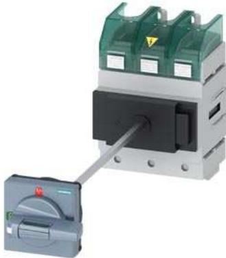
SENTRON, Lasttrennschalter 3LD5 UL, Hauptschalter, 3-polig, approbiert nach UL489, UL60947-4-1 und IEC60947-3, UL: 100A, SCCR 65kA at 480VAC, Betriebsleistung @ 480VAC 3-phasig: 60hp, IEC: 100A, Betriebsleistung bei AC-23A bei 400V: 45kW, Bodenbefestigung mit Türkupplung, überlistbarer Drehantrieb, Standard, 4-Loch Befestigung der Handhabe, ohne Toleranzausgleich, inklusive Klemmenabdeckungen für die Einspeiseseite
