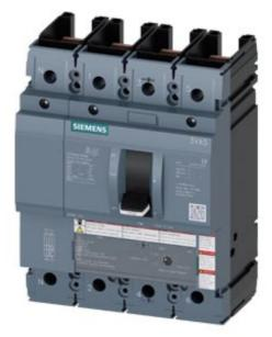
Leistungsschalter 3VA5 UL Frame 250 Schaltvermögenklasse H 65kA @ 480V 4-polig, Anlagenschutz TM210, FTFM, In=90A Überlastschutz Ir=90A fest eingestellt Kurzschlussschutz Ii=10 x In N-Leiterschutz 100% ohne Anschluss
