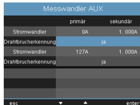
Abb. Überwachung für Differenzstrommessung konfigurieren
