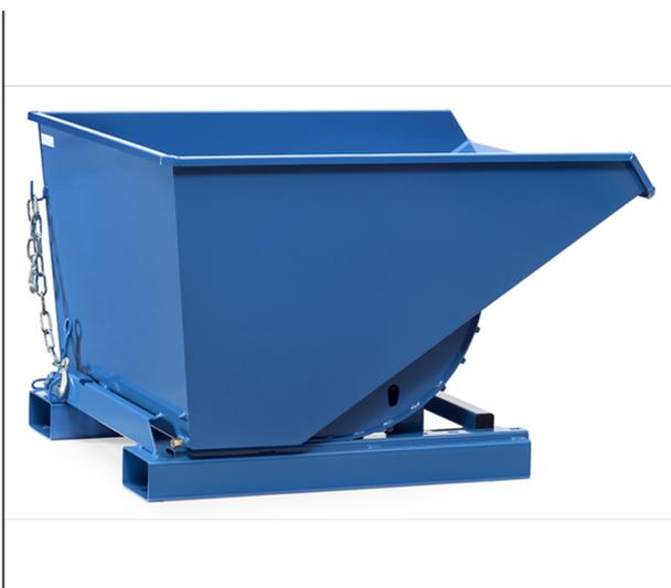
Construction robuste en tôle d'acier de 3 mm mécano-soudée et étanche. Revêtement époxy bleu RAL 5007. De série avec passage de fourches. Versement sans risque de basculement, verrouillage anti-ouverture et chaîne de sécurité. Système d'ouverture par câble ramené au siège du conducteur. Livrée avec câble. Roues en option.
