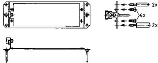
Halterahmen mit 2 Schutzkontakt-Buchsen und Schutzleiter-Klemme
