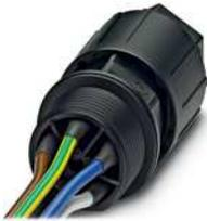
Wanddurchführung, QUICKON-Anschluss, Polzahl: 4+PE, 0,5 mm<sup>2</sup> ... 1,5 mm<sup>2</sup>, 690 V, 17,5 A, schwarz, mit QUICKON-Mutter, Leitungsaußendurchmesser: 10 mm ... 14 mm, Montagegewinde: M25, Einzeladern, 1,5 mm<sup>2</sup>, Leitungslänge: 0,5 m
