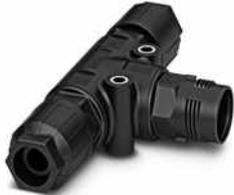
T-Verteiler, QUICKON-Anschluss, Polzahl: 4+PE, 0,5 mm<sup>2</sup> ... 1,5 mm<sup>2</sup>, 690 V, 17,5 A, schwarz, mit zwei QUICKON-Muttern, Leitungsaußendurchmesser: 10 mm ... 14 mm
