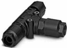
T-Verteiler, QUICKON-Anschluss, Polzahl: 4+PE, 0,5 mm<sup>2</sup> ... 1,5 mm<sup>2</sup>, 690 V, 17,5 A, schwarz, mit drei QUICKON-Muttern, Leitungsaußendurchmesser: 10 mm ... 14 mm
