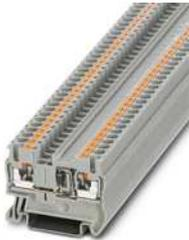
Bauelementreihenklemme, Der max. Strom wird durch die Diode bestimmt. Eingebaut: Diode 1N 4007, Sperrspannung: 1300 V, Dauergrenzstrom: 0,5 A., mit integrierter Diode 1N4007, Nennspannung: 800 V, Nennstrom: 0,5 A, Anschlussart: Push-in-Anschluss, Bemessungsquerschnitt: 2,5 mm<sup>2</sup>, Querschnitt: 0,14 mm<sup>2</sup> - 4 mm<sup>2</sup>, Montage: NS 35/7,5, NS 35/15, Farbe: grau
