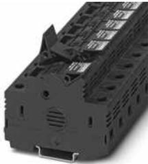
Sicherungshalter, Art der Sicherung: Glas / Keramik / ..., Sicherungstyp: gPV 10,3 x 38 mm nach 60269-6, Nennspannung: 1000 V, Nennstrom: 30 A, Anschlussart: Schraubanschluss, Bemessungsquerschnitt: 16 mm<sup>2</sup>, Querschnitt: 0,75 mm<sup>2</sup>- 25 mm<sup>2</sup>, Montageart: NS 35/7,5, NS 35/15, NS 32, Farbe: schwarz
