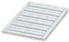
Marker für Klemmen, Matte, weiß, unbeschriftet, beschriftbar mit: TOPMARK NEO, TOPMARK LASER, BLUEMARK ID COLOR, BLUEMARK ID, BLUEMARK CLED, THERMOMARK PRIME, THERMOMARK CARD 2.0, THERMOMARK CARD, Montageart: verrasten, für Klemmenbreite: 16 mm, Schriftfeldgröße: 15,2 x 4,7 mm, Anzahl der Einzelschilder: 24
