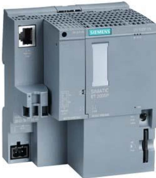
SIPLUS ET 200SP CPU 1510SP-1 PN -40...+60°C mit Conformal Coating based on 6ES7510-1DJ01-0AB0 . CPU 1510SP-1 PN für ET 200SP, Zentralbaugruppe mit Arbeitsspeicher 100 KB für Programm und 750 KB für Daten, 1. Schnittstelle: PROFINET IRT mit 3 Port Switch, 72 NS Bit-Performance, SIMATIC Memory Card notwendig, Busadapter notwendig
