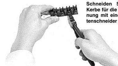
Schneiden Sie die Kerbe für die Abtrennung mit einem Seitenschneider durch.
