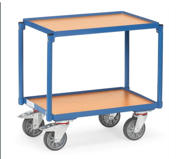
Etagen-Roller mit 2 Plattformen. Beide Rahmen mit Böden aus Holzwerkstoffplatte, Oberfläche Buchendekor, Rand 15 mm hoch. Pulverbeschichtet blau RAL 5007. Lichter Etagenabstand 400 mm. Tragkraft obere Ladefläche 100 kg. 4 Lenkrollen mit TPE-Bereifung, Naben mit Rillenkugellager. 2 Stück mit Feststeller, gemäß der Europäischen Norm EN 1757-3 (Sicherheit von Plattformwagen). Passend für Eurokästen 600 x 400 mm. Zerlegte Anlieferung.
