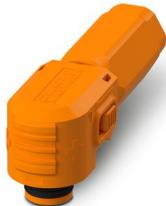
Steckverbinder für Energiespeicher, Artikelfamilie: BPC, Steckverbinder, Farbe: orange, Polzahl: 1, Aderquerschnitt min.: 50 mm<sup>2</sup>, Aderquerschnitt max.: 70 mm<sup>2</sup>, Bemessungsspannung: 1500, Bemessungsstrom: 250 A, Anschlussart: Crimp, Kontaktart: Buchse, Kabeldurchmesser min.: 14,5 mm, Kabeldurchmesser max.: 17 mm
