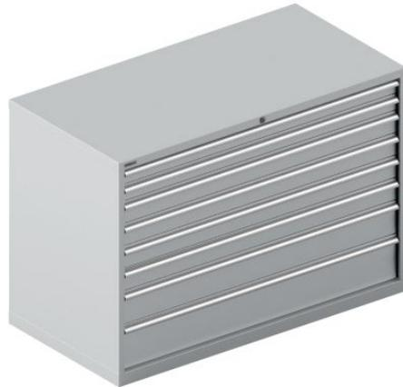
Die Schubladen sind alle mit Vollauszügen ausgestattet, die einen optimalen Zugriff und eine maximale Raumausnutzung ermöglichen. Belastet werden können sie je nach Ausführung mit 75 oder 200 kg. Die Schubladen mit 50 mm Blendenhöhe gibt es konstruktionsbedingt nur mit 75 kg Traglast, ab 150 mm Blendenhöhe haben die Schubladen alle einen 200 kg Auszug. Die Doppelauszugssperre sorgt für einen sicheren Stand.
