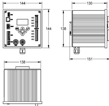
ECC2 Funktionscontroller - A3000 open mit Ethernet- und CAN-Busanschluss für die Armaturenebene sowie mit integriertem Netzteil, Echtzeituhr mit Kalenderfunktion und WEB - Server. Zum Anschluss von 32 AQUA 3000 open Armaturen/Systemelektronikmodulen beziehungsweise bis zu 200 m Kabellänge zwecks Spannungsversorgung und externer Steuerung wie Armatureneinstellung und Kommunikation. Inklusive GLT - Datenprotokolle für BacNet - IP, KNX - IP und ModBus - TCP, 230 V AC / 24 V DC.
