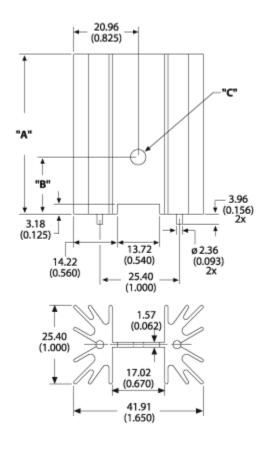
A Dim **38.10**B Dim **18.29**C Dim **3.17**
