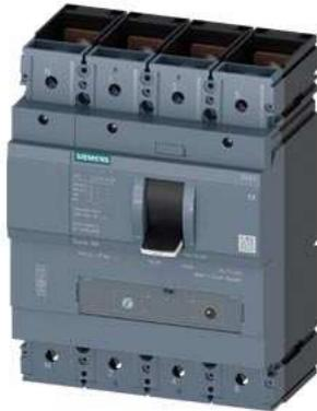
Leistungsschalter 3VA1 IEC Frame 400 Schaltvermögenklasse C Icu=110kA @ 415 V 4-polig, Anlagenschutz TM240, ATAM, In=320A Überlastschutz Ir=224A ...320A Kurzschlusschutz Ii=5...10 x In N-Leiterschutz 1 Schraubenflanschanschluss
