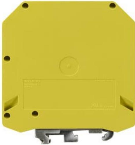
SCHUTZLEITERKLEMME MIT SCHRAUB-ANSCHLUSS, QUERSCHNITT: 35 - 95 QMM, AWG: 2 - 4/0, BREITE: 25 MM, FARBE: GRUEN-GELB
