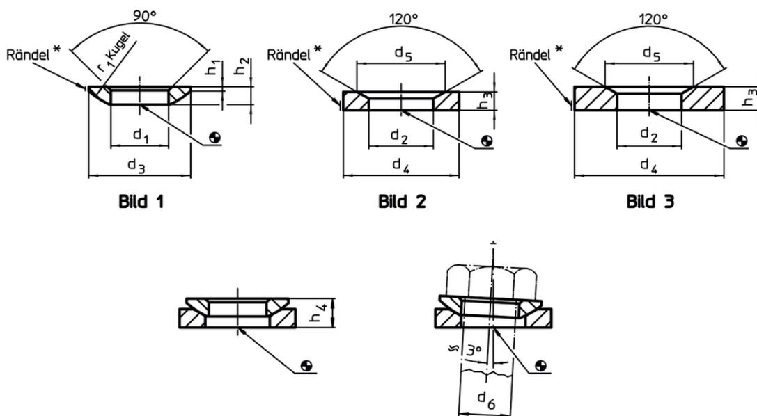
\* Rändel: Materialkennzeichnung für Ausführung rostfreier Stahl A4
