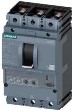
Leistungsschalter 3VA2 IEC Frame 250 Schaltvermögenklasse L Icu=150kA @ 415V 3-polig, Anlagenschutz ETU330, LIG, In=160A Überlastschutz Ir=63A...160A Kurzschlusschutz Ii=1,5...12 x In Erdschlussschutz Ig=0,2...1 x In, tg=0,1/0,3s Schraubenflanschanschluss
