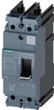
Leistungsschalter 3VA5 UL Frame 125 Schaltvermögenklasse H 65kA @ 480V 2-polig, Anlagenschutz TM210, FTFM, In=100A Überlastschutz Ir=100A fest eingestellt Kurzschlusschutz Ii=10 x In ohne Anschluss
