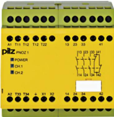
Sicherheitsschaltgerät (standalone), Eingänge: 1/2-kanalige Beschaltung ohne Querschlusserkennung, Ausgänge: 3 S, 1 Ö, UB = 230 - 240 V AC, Breite: 90 mm, Schraubklemmen integriert, Überwachung von Not-Halt, Schutztüren, Rückführkreis.
