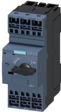
Leistungsschalter Baugröße S0 für Starterkombination Bemessungsstrom 4 A N-Auslöser 52 A Federzuganschluss Standardschaltvermögen
