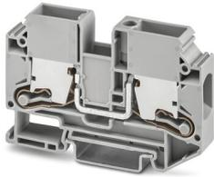
Durchgangsklemme, Nennspannung: 1000 V, Nennstrom: 76 A, Anzahl der Anschlüsse: 2, Polzahl: 1, Anschlussart: Push-X-Anschluss, Bemessungsquerschnitt: 16 mm<sup>2</sup>, Querschnitt: 2,5 mm<sup>2</sup> - 25 mm<sup>2</sup>, Montageart: NS 35/7,5, NS 35/15, Farbe: grau
