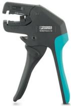
Abisolierwerkzeug, für Leitungen und Leiter von 0,02 - 10 mm<sup>2</sup>, selbstjustierend, Abisolierlänge bis 18 mm, Schneidvermögen bis 10 mm<sup>2</sup> flexibel /1,5 mm<sup>2</sup> starr, Abisoliermesser austauschbar
