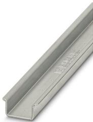
Tragschiene ungelocht, nach EN 60715, Material: Stahl, verzinkt, dickschichtpassiviert, Standardprofil 2,3 mm, Farbe: silberfarben, Verpackungsvariante mit 10 Stück (20 m)
