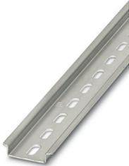
Tragschiene gelocht, nach EN 60715, Material: Stahl, verzinkt, dickschichtpassiviert, Standardprofil, Farbe: silber, Verpackungsvariante mit 25 Stück (50 m)
