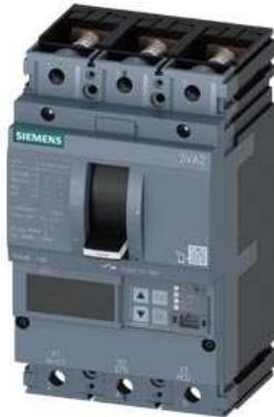
Leistungsschalter 3VA2 IEC Frame 160 Schaltvermögenklasse E Icu=200 kA @ 415 V 3-polig, Motorschutz ETU860M, LSIG, In=25A Überlastschutz Ir=10A ... 25A Kurzschlusschutz Isd=1,2...15xIn, li=3...15xIn Schraubenflachanschluss
