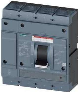
Leistungsschalter 3VA5 UL Frame 800 Schaltvermögenklasse H 65kA @ 480 V 4-polig, Anlagenschutz TM230, FTAM, In=600A Überlastschutz Ir=600A fest eingestellt Kurzschlusschutz Ii=5...10 x In N-Leiter ungeschützt beidseitig Kabelanschluss
