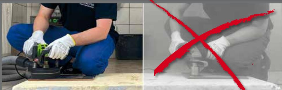
Bester **Schutz des Anwenders vor gefährlichen mineralischen Stäuben** durch Absaugung, im Vergleich zu herkömmlichen Methoden mit Winkelschleifer
