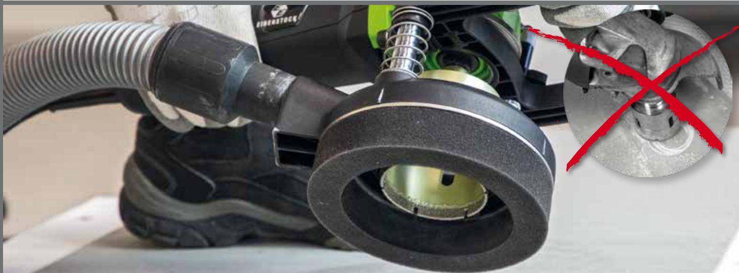
**Präzises Bohren**, kein Abgleiten der Bohrkronen durch rutschfesten Schaumstoff
