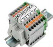
Beschriftungsstreifen (2009-110) eingesetzt in die Beschriftungsaufnahme mit Brückersymbolik des eingesetzten Brückers (Sternbrücker 2000-405/011-000) (hier am Beispiel Klemmen mit Drücker)
