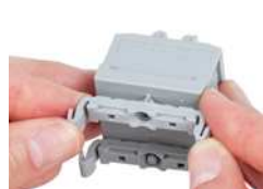
Klemmenleiste; mit Rastfüßen Anrasten des Montagefußes (209-120) (Der Abstand der Montagefüße zueinander unter einer Klemmenleiste soll ca. 20 ... 25 mm betragen.)
