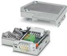
D-SUB-Stecker, 9-polig, Stift, Kabelzuführung unter 35°, Bussystem: PROFIBUS DP bis 12 MBit/s mit Pg-D-SUB-Buchse z. Anschluss eines Programmiergeräts, Abschlusswiderstand ü. Schiebeschalter zuschaltbar, Pinbelegung: 3, 5, 6, 8; Federkraftanschlussklemmen
